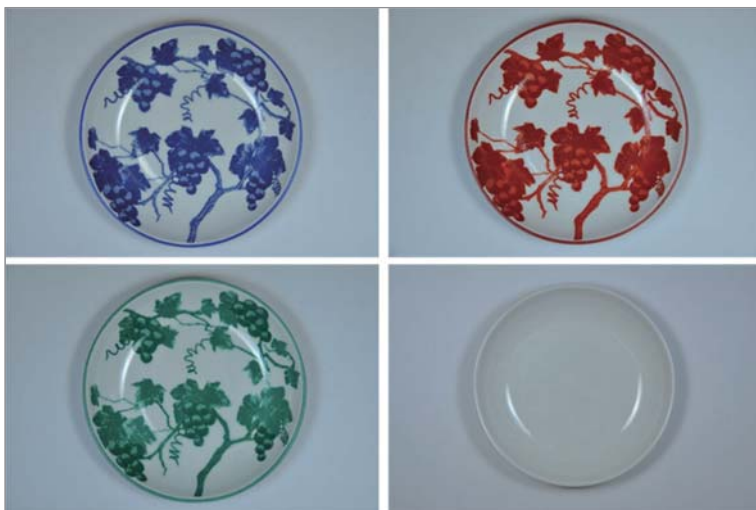
図2 焼成した小皿と白色の皿 直径11cmの強化磁器の小皿を実際に焼成した。3色の単色絵柄と絵柄のない白色の皿とした。
